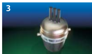
3 Обработка на установке печь-ковш
