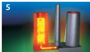
5 Сифонная разливка стали
