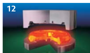
12 Штамповка на прессе 10000 тонн
