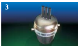
3 Обработка на установке печь-ковш
