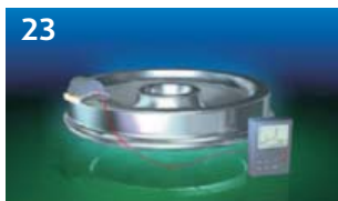
23 Ультразвуковой, магнитопорошковый контроль
