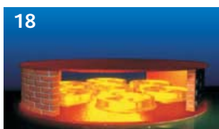
18 Нагрев колес под закалку
