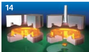
14 Калибровка колеса на прессе 35/8 и прошивка отверстия в ступице
